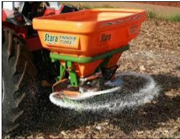
Figura 20 – Distribuidor TWISTER 1500 - de sementes e fertilizantes.
