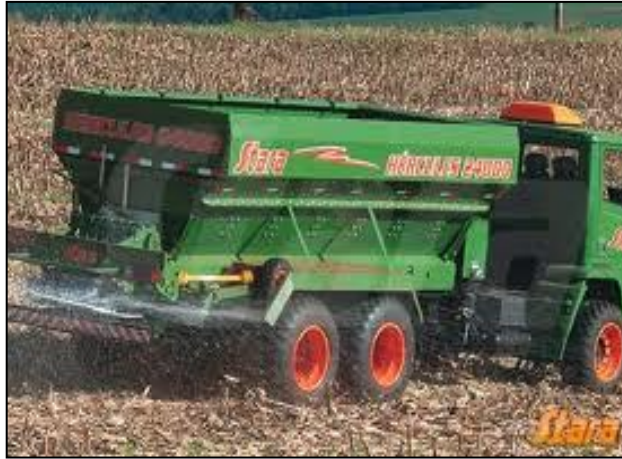
Figura 19 – Aplicador da AMAZONE da STARA com distribuidor centrífugo.
